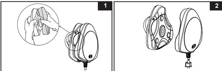
2. Platzieren Sie den Transmitter (2) auf der Außenseite der Poolwand und die Poolbeleuchtung (1) auf der Innenseite der Poolwand, unter Wasser. Versichern Sie sich, dass die Transmittermagnetpole genau mit den Magnetpolen auf der Poolbeleuchtungseinheit ausgerichtet sind. **Siehe dazu Zeichnung (3).**
